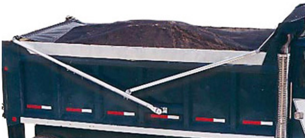
Photo A20.1 Exemple de bâche maintenue de manière appropriée pour le transport d'enrobé
