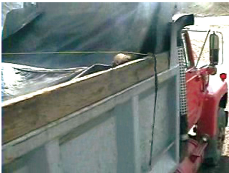
Photo A20.4 Exemple de bâche maintenue de manière appropriée pour le transport d'enrobé
