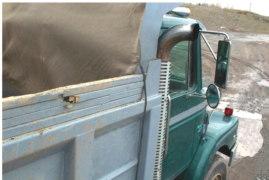
Photo A20.3 Exemple de bâche maintenue de manière appropriée pour le transport d'enrobé
