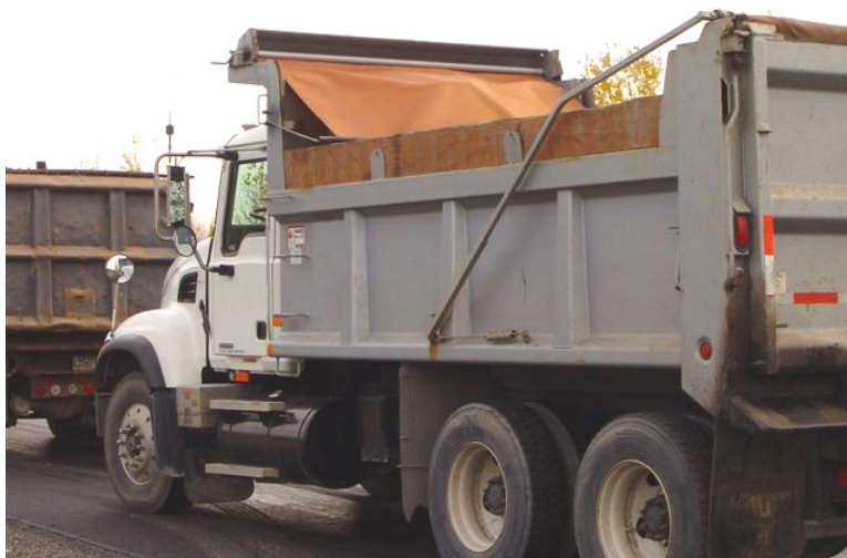
Photo A20.2 Exemple de bâche maintenue de manière appropriée pour le transport d'enrobé
